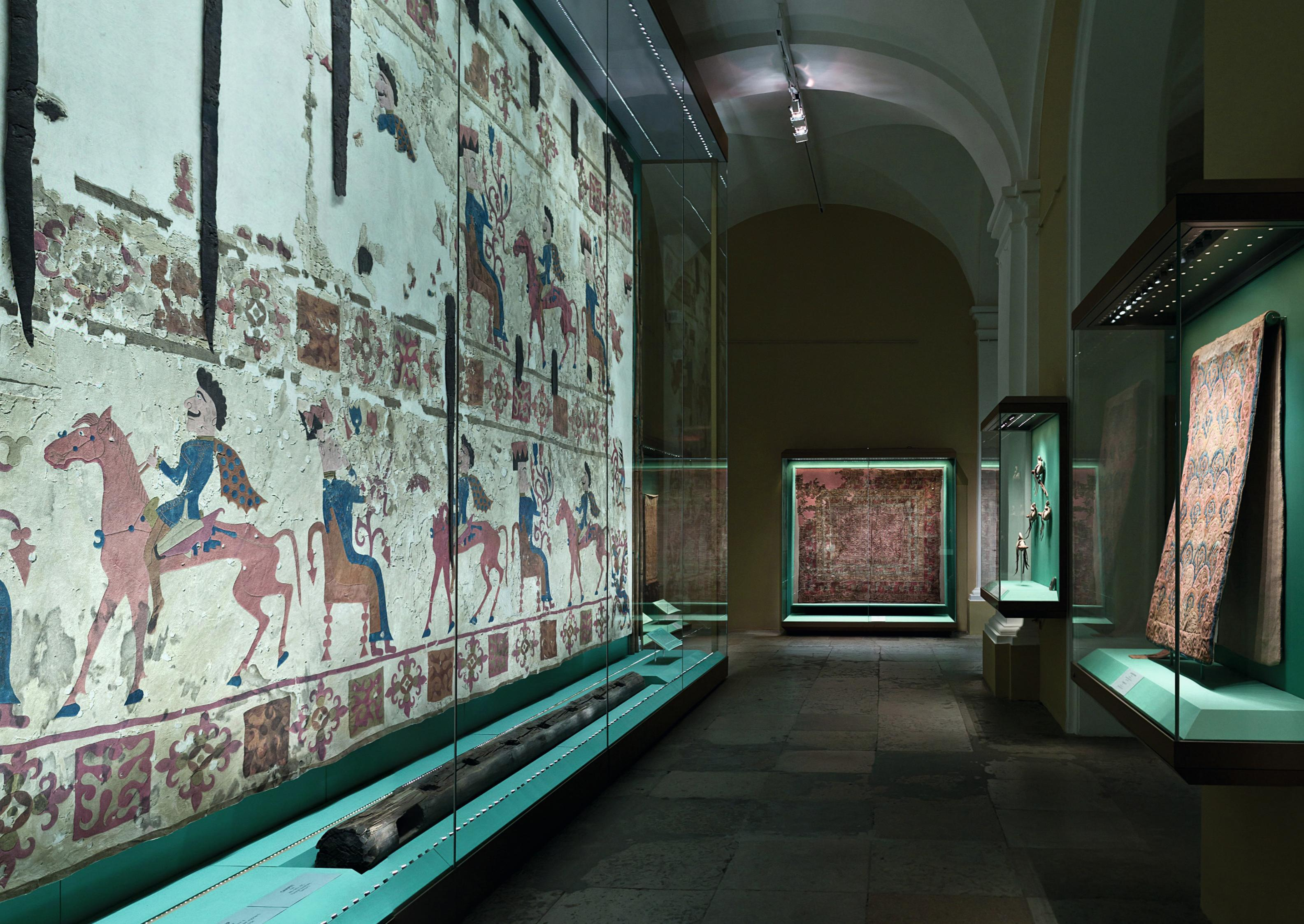
Eine besondere Leistung stellt die Großraumvitrine für den größten ausgestellten geknüpften Teppich dar. Sie hat eine Grundfläche von 8 mal 1 Meter und ist 6 Meter hoch. Auf Grund der Raumsituation boten sämtliche bekannten Öffnungstechniken keine Lösung. REIER entwickelte also Faltschiebetüren, die trotz eines Gewichtes von einer Tonne pro Scheibenpaar von einer einzigen Person mühelos bedient werden können.
